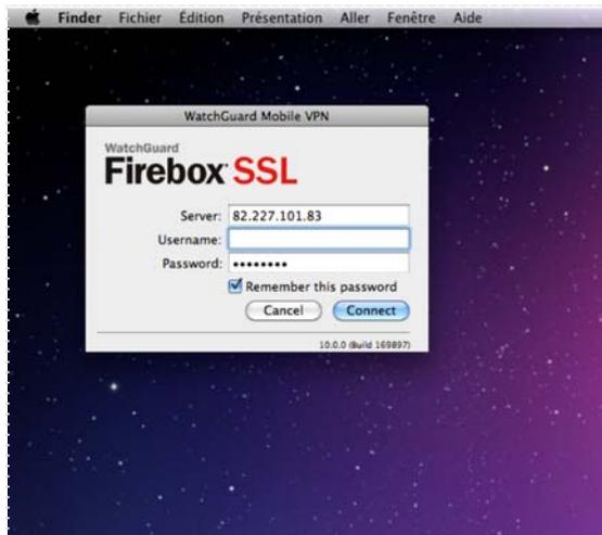
Création d'un « tunnel Vpn » sécurisé avec un logiciel lié au firewall
